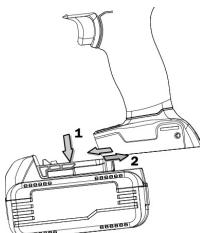
1. Éteignez toujours la machine avant d'insérer ou de retirer la batterie.
