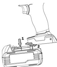
1. Zawsze wyłączyć maszynę przed zamontowaniem lub wyjęciem akumulatora.
