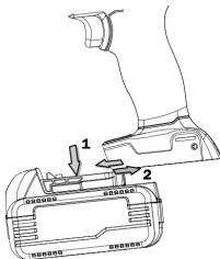
1. Всегда выключайте устройство перед установкой или извлечением аккумуляторного блока.
