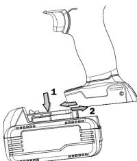
1. Apague siempre el aparato antes de instalar o extraer la batería.
