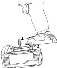
1. Enne aku paigaldamist või eemaldamist lülitage seade alati välja.
