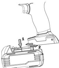
1. Sluk altid for maskinen, inden batterienheden monteres eller afmonteres.
