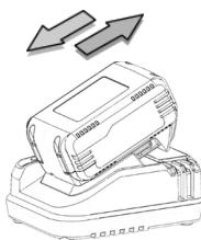
4. Setzen Sie den Akku vollständig ein und stellen Sie sicher, dass das rote Lämpchen am Ladegerät „AN“ ist. Der Akku startet nun den Ladezyklus.
