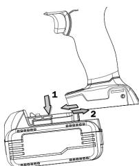
1. Schakel altijd de machine uit voordat de accu wordt geplaatst of verwijderd.
